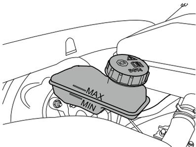
如果液位低于“MIN”标记，则信息中心显示屏上的“制动系统警告灯（红色）”将会亮起。这表示制动系统出现故障，必须立即查明原因。如果正在行驶，请立即将车小心停下。应尽快联系本公司授权服务商检修。切勿继续行车。
