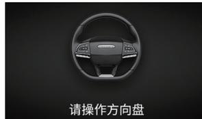
如果驾驶员不响应此提示以操控车辆，声音警告将发出并且LKA被置于待机模式，此时该功能将不可用，同时组合仪表信息中心上提示“车道保持退出，请接管方向盘”。
