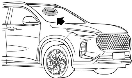
摄像头单元位于挡风玻璃上部，如果驾驶员组合仪表信息中心显示“请清理前挡风玻璃”、“摄像头系统故障”，则表示摄像头单元无法探测到本车前方的其它车辆。下表所示为有关故障信息显示的可能原因示例，以及相应的处理措施：
