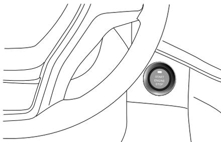
**提醒：**车辆配备有一键启动开关，即按键式起动的启停开关，若要使车辆启动，带PEPS遥控钥匙必须在车内。若要换出驻车挡，车辆必须处于ON位置，且必须踩下制动踏板。
