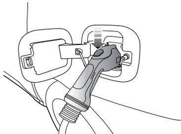
**提醒：**如果需要提前结束充电取出充电枪，请用智能钥匙或普通钥匙将车辆解锁，车辆会自动停止充电，“充电状态指示灯（黄色）”会熄灭，电子锁自动解锁，然后4分钟内按压充电枪上的按钮开关取下充电枪（若超过4分钟内未取下充电枪则充电接口的电子锁会重新上锁），最后将上电开关打回上锁位置。
