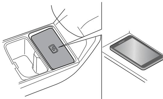
将手机按照上图所示（手机屏幕向前）进行放置，手机中心对准充电符号。当手机进行充电时，会有蜂鸣器声音提示。当车辆熄火时，如果车辆识别到手机还在充电，则通过蜂鸣器提醒驾驶员。
