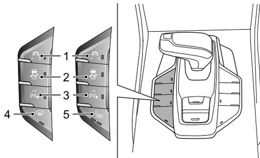
位置1 -  $\text{A}$ ：车道偏离预警开关。点火开关打到“ON（开启）”位置时，车道偏离预警默认开启，开关上的指示灯点亮。按下开关（1），关闭车道偏离预警系统，开关上的指示灯熄灭，组合仪表上的“车道偏离预警警告灯”呈黄色点亮。再次按下开关（1）即可启动车道偏离预警。更多信息请参阅起动与驾驶章节中的“驾驶辅助系统”。
