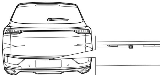
**提醒：**在车辆进入倒车状态时，摄像头输出静态倒车轨迹，静态倒车轨迹是以地平面为参照物，并显示在娱乐系统显示屏上，采用红、黄、绿三种颜色分段标识。
