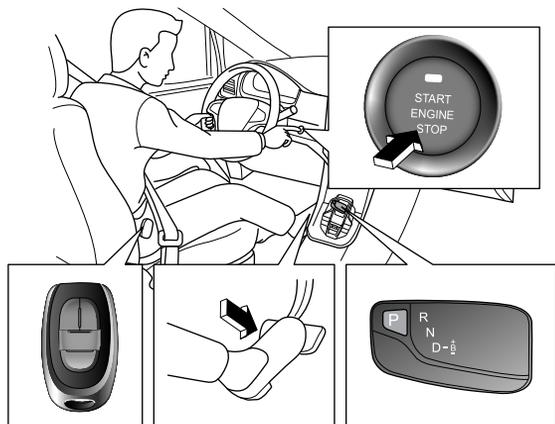
**提醒：**如果不满足起动条件，每按一次启停开关，电源挡位将在OFF、ACC、ON之间循环切换。如果遥控钥匙不在车内，踩住制动踏板，指示灯不会亮，按下启停开关也将不会执行切换电源挡位或者点火动作。
