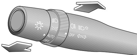
将拨杆开关推离方向盘，以将前大灯从近光改为远光。将拨杆开关拉近方向盘，以回到近光位置。
