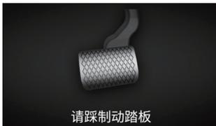
自适应巡航控制系统可利用脚制动器制动能力的约40%，如果在高速工况下前车紧急刹车，自适应巡航控制不足以将车辆减速至安全的车速范围，此时组合仪表会提示“请踩制动踏板”，驾驶员必须立即采取制动措施。
