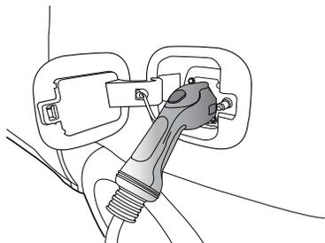
7 当充电枪连接完成后，组合仪表上的“充电连接指示灯（红色）”会点亮，充电插座电子锁上锁，此时充电枪上的按钮开关无法按下，保证充电过程中无法带电拔枪。
