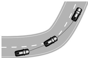
在某些情况下，车道辅助系统允许车辆越过车道线而不启用转向辅助或发出警告。当使用方向指示灯时或当驾驶员“转过”急弯路时，会发生这种情况。驾驶员主动关闭ESP时（即按下ESP OFF开关，开关上指示灯点亮，组合仪表上的ESP OFF指示灯点亮，ESP系统关闭），LKA将不会介入。
