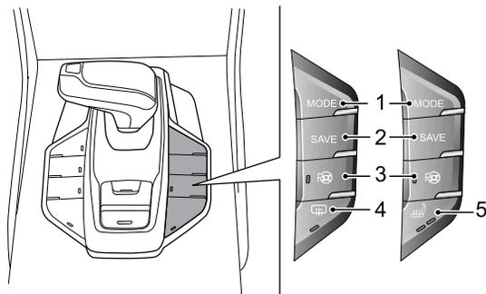
位置1 - **MODE**：驾驶模式开关。根据驾驶需要，依次按下开关（1），驾驶模式切换顺序是：**ECO**（经济模式）→**SPORT**（运动模式）→**NORMAL**（常规模式），如此循环，默认模式为**NORMAL**（常规模式）。同时组合仪表信息中心显示：**ECO**→**SPORT**→**NORMAL**。在不同的驾驶模式，混动控制系统能够采用不同的控制策略，进行输出控制。
