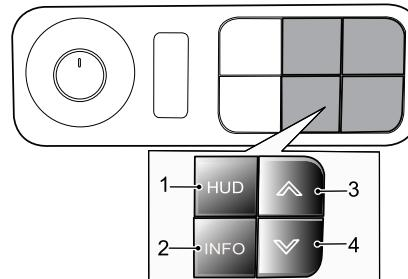
位置1 - **HUD**: 抬头显示开关。短按开启显示功能，长按1秒关闭显示内容。
