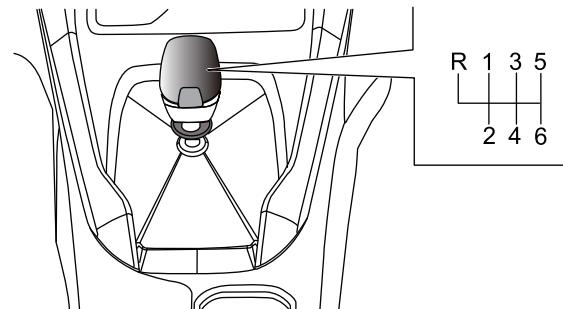
**6挡：**用大于弹簧压力的力将换挡杆完全选至右侧，然后推至下方。降至5挡时，切勿向左侧施加横向压力，否则可能意外换到3挡。从而导致发动机超速运转。
