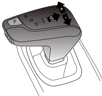
在自动模式D挡时，向右拨动换挡杆可切换至S挡运动模式，向前或向后推拉换挡杆可变换挡位。
