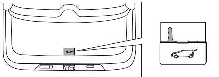
要关闭尾门，可放低尾门并牢固按下，确定尾门牢固锁定。
