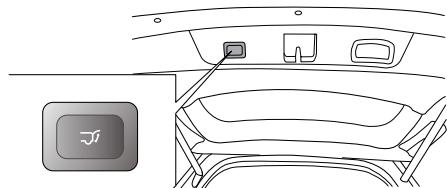
**提醒：**尾门向上摆动打开。打开尾门时，要确定在车辆后部附近没有物体或人。驾驶车辆前确定已关闭尾门。如果在没有关闭尾门的情况下驾驶车辆，可能会导致尾门气压举升器和其他部件的损坏。
