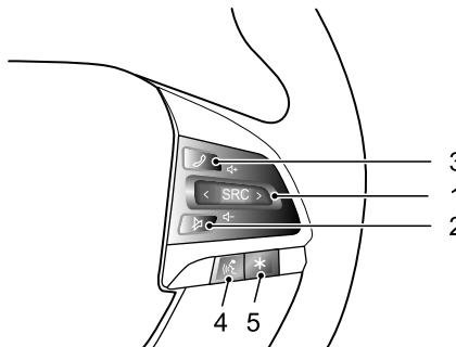
位置1 -
