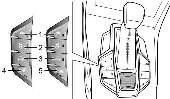
位置1 - ：车道偏离预警开关。点火开关打到“ON（开启）”位置时，车道偏离预警默认开启，开关上的指示灯点亮。按下开关（1），关闭车道偏离预警系统，开关上的指示灯熄灭，组合仪表上的“车道偏离预警警告灯”呈黄色点亮。再次按下开关（1）即可启动车道偏离预警。更多信息请参阅起动与驾驶章节中的“驾驶辅助系统”。
