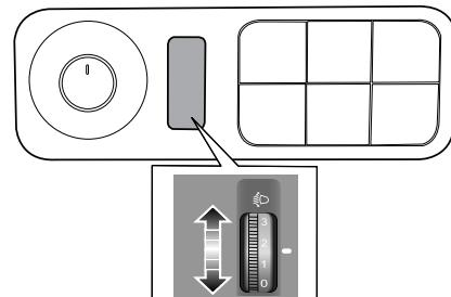
向上或向下移动前大灯高度调节开关调节前大灯高度。0档为初始档位，随着车辆负载的增加，请按照1 - 2 - 3档的顺序对照明高度进行调整。
