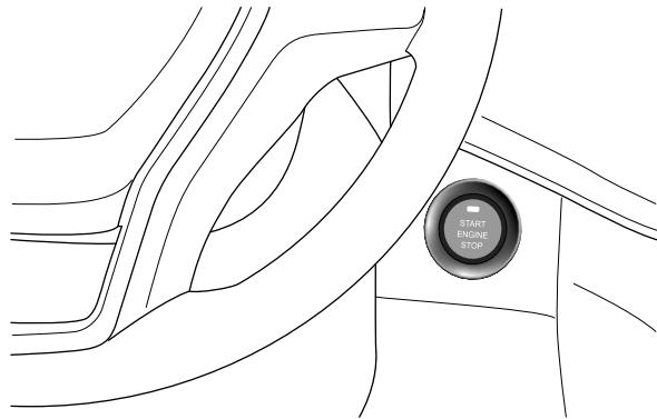
**提醒：**车辆配备有一键启动开关，即按键式起动的启停开关，若要使车辆启动，带PEPS遥控钥匙必须在车内。对于自动变速器车型若要换出驻车挡，车辆必须处于ON位置，且必须踩下制动踏板。
