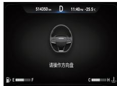
如果驾驶员不响应此提示以操控车辆，声音警告将发出并且LKA被置于待机模式，此时该功能将不可用，同时组合仪表信息中心上提示“车道保持退出，请接管方向盘”。
