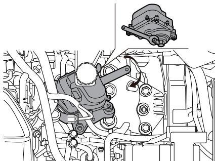
**提醒：**转动扳手前请确保工具完全卡住换挡轴。
