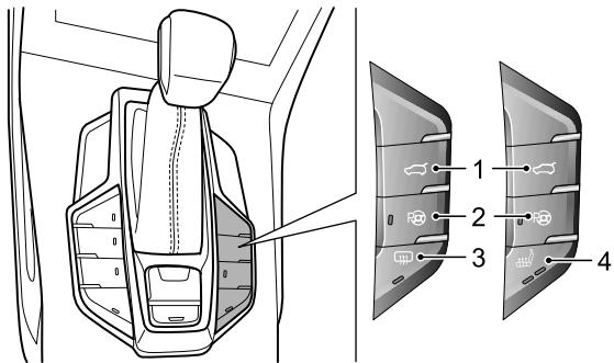
位置1 - ：电动尾门开关。当电动尾门关闭时，按下开关（1），电动尾门会解锁然后自动开启，组合仪表后尾门状态会由关闭转变为开启。再按一下开关（1）可以关闭电动尾门。
