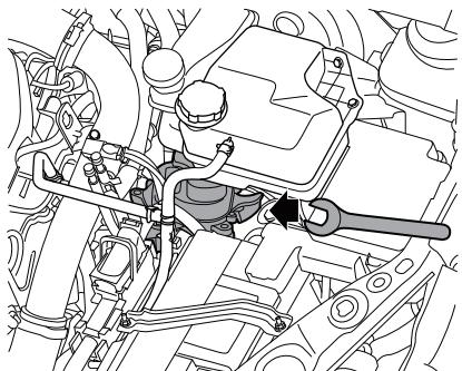
4 将扳手伸入换挡执行器，卡住变速箱换挡轴，顺时针方向转动扳手，解除P挡。
