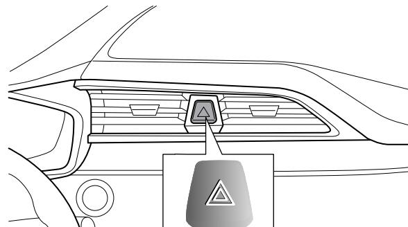
按下危险警告灯开关△同时激活所有转向灯, 组合仪表上的“转向指示灯(绿色)”点亮闪烁。再按下此开关即可关闭上述灯。
