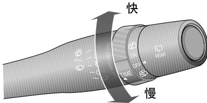
对于未配备雨量传感器的车辆，当拨杆开关位于 $\square$ （间歇）位置时，旋转开关以改变刮水间隔时间。
