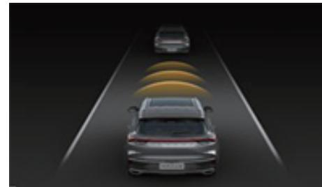
**提醒：当前方车辆指示灯显示时，自适应巡航以预先设定的时间间隔跟随前车。**
