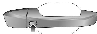
关闭点火开关，离车关门时，用拇指轻触车门把手上的微动开关，就可以让车门上锁，无须按下遥控钥匙上的上锁按键。
