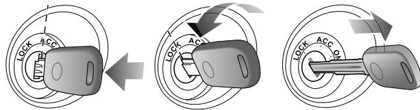
为了将钥匙从点火开关中拔出，先将其逆时针旋转至“ACC（解锁）”位置。然后将钥匙朝点火开关压下并继续逆时针旋转至“LOCK（上锁）”位置。此时即可拔出钥匙。
