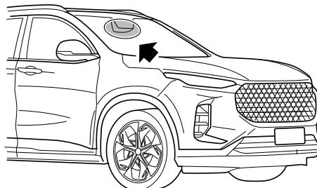
摄像头单元位于挡风玻璃上部，如果驾驶员组合仪表信息中心显示“请清理前挡风玻璃”、“摄像头系统故障”，则表示摄像头单元无法探测到本车前方的其它车辆。下表所示为有关故障信息显示的可能原因示例，以及相应的处理措施：
