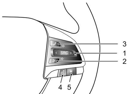
位置5 - \*：自定义设置开关。按下此开关开启自定义设置。请与带车联网功能娱乐系统中支持自定义设置的相关功能结合使用。
