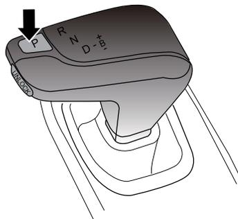
车辆静止时，按压P挡按钮，车辆进入P挡。
