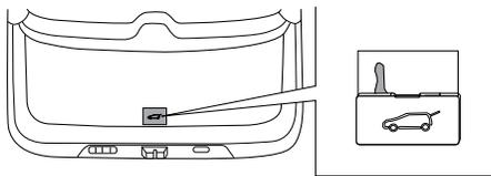
要关闭尾门，可放低尾门并牢固按下，确定尾门牢固锁定。
