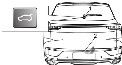
**提醒：**如果由于轻关尾门而导致尾门未锁紧无法正常打开时，有两种简单的方法可以开门：1、按尾门开关（1）的同时向上抬门（2）；2、先将门（2）推到全锁状态再正常开门。
