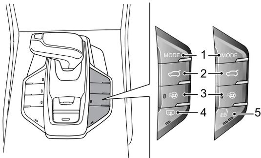
位置1 - **MODE**: 驾驶模式开关。根据驾驶需要, 依次按下开关(1), 驾驶模式切换顺序是: **ECO** (经济模式) → **SPORT** (运动模式) → **NORMAL** (常规模式), 如此循环, 默认模式为 **NORMAL** (常规模式)。同时组合仪表信息中心显示: **ECO** → **SPORT** → **NORMAL**。
