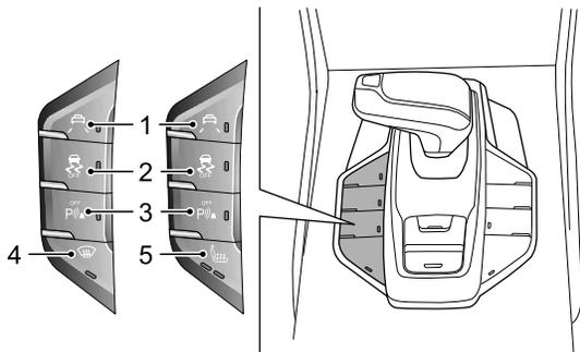
位置1 -
