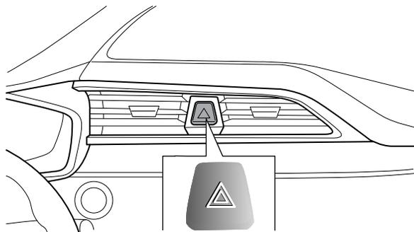
按下危险警告灯开关 $\triangle$ 同时激活所有转向灯，组合仪表上的“转向指示灯（绿色）”点亮闪烁。再按下此开关即可关闭上述灯。
