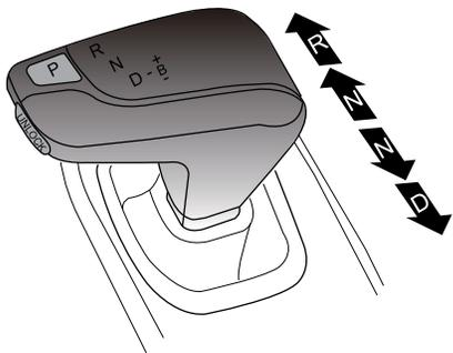
朝所需的方向短促推、拉换挡杆（前后各两个位置）。松开换挡杆后，换挡杆会返回到中间位置。
