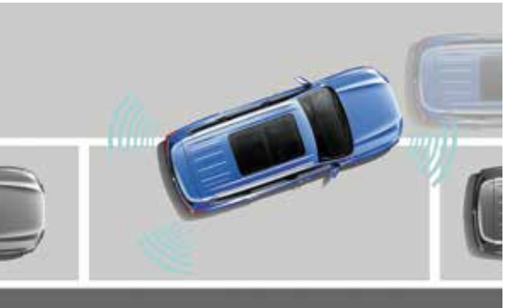
>> APA自动泊车系统 超声波传感器扫描判断入库空间，轮速传感器定位车辆空间位置。驾驶员只需挂入R档，控制制动踏板即可完成泊车。
