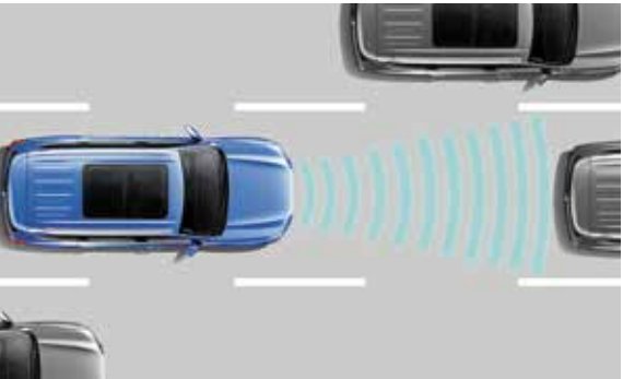
>> ACC自适应巡航系统 能够通过智能控制油门和刹车实现0-150km/h自动跟车功能，即便在等待红灯起步或者拥堵路段的进行中，跟随车辆都能继续使用这项功能，解放双脚。
