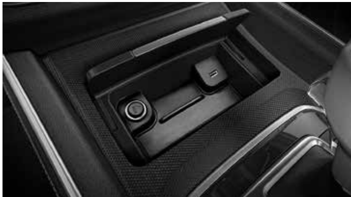
>> 无线智能充电 具有充电指示灯功能，充上电时显示为绿色，充满电时指示灯熄灭，位置不正确时橙色灯闪烁，充电故障时橙色灯持续点亮。配合市面上具有无线充电功能手机，节省充电接口可以做其他用处。
